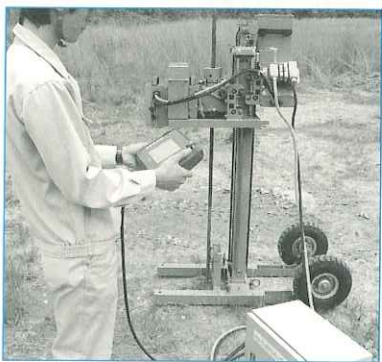
写真2 | 最近普及してきている機械によるSWS試験 (写真提供:ワイビーエム)
