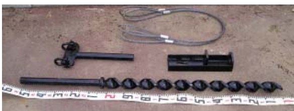
写真2 スパイラル式アンカー
