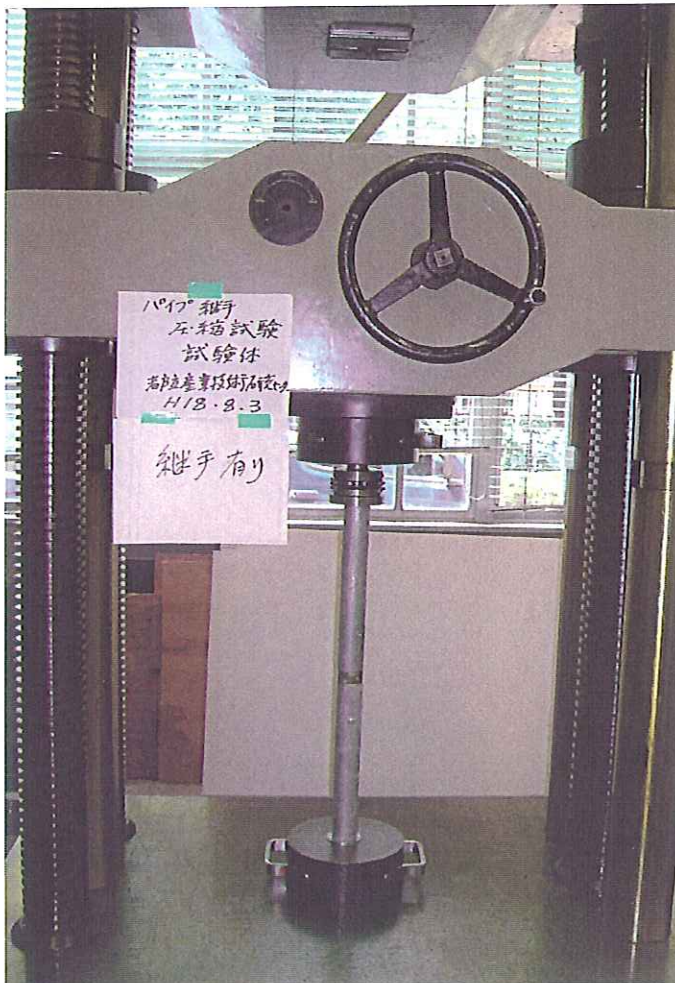
写真-4 圧縮試験 (継ぎ手あり)
