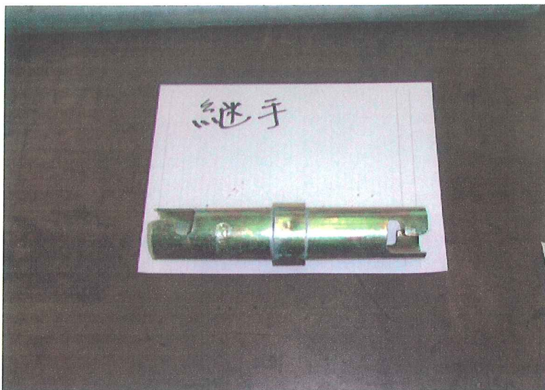
写真-1 継ぎ手冶具
