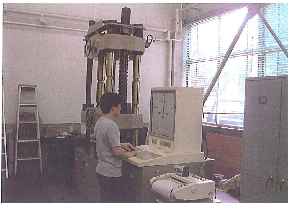
写真-2 1,000 kN アムスラー (圧縮試験機)
