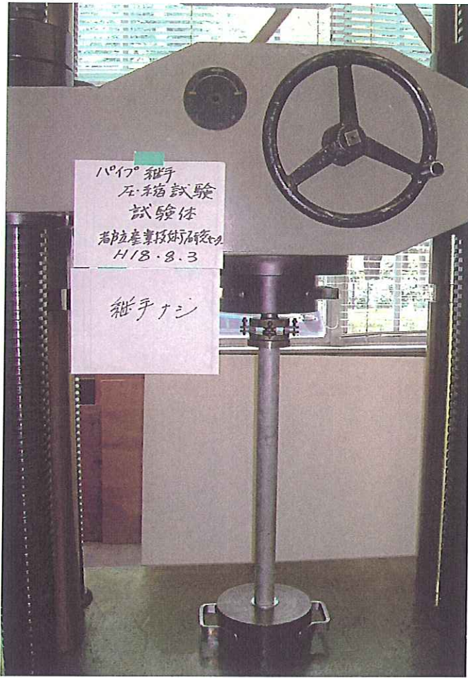
写真-3 圧縮試験 (継ぎ手なし)
