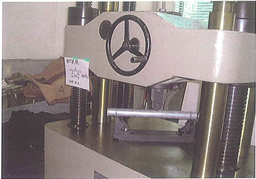
写真-5 曲げ試験 (継ぎ手なし)
