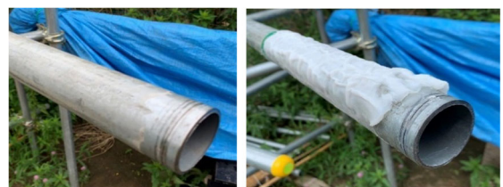
写真 1 フリクションカット材の散水前後の状態
