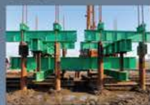
▲載荷試験状況 数多くの載荷試験により、どんな地盤にも確実な支持力を発揮することが確認されました。
